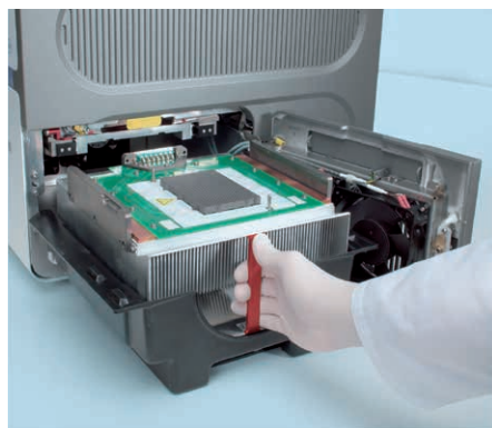
▲ 図1：LightCycler ® 480 サーマルブロックユニットの高い柔軟性。LightCycler ® 480 サーマルブロックユニット（96-ウェル/384-ウェルフォーマット）は、お客様自身によって、わずか数分で簡単に交換できます。交換されたサーマルブロックは自動的に識別され、再キャリブレーションの必要性もないため、無駄な時間を浪費することなく実験を続行することができます。
