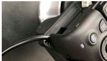
↑ケーブルを出す位置についてもご注意ください。 本体の側面部の切込みは、外側に開きます。
