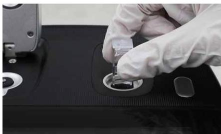
※光路の方向は左図矢印で示すように、キュベット挿入口の上から下になります。
