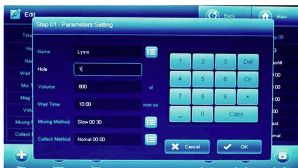
選択したステップのName (ステップ名)、Hole (プレート列No.)、Volume (容量)、Wait Time (待ち時間)、Mixing Method (混合方法)、Collect Method (回収方法)を設定します。Nameのリストボックスをクリックすると、ステップ名選択リストがポップアップ表示されます。ステップ名は、各ステップの実行内容を明確にするために設定します。ステップ名の追加・削除方法については、ステップ名管理の項目 (p.19)を参照してください。
