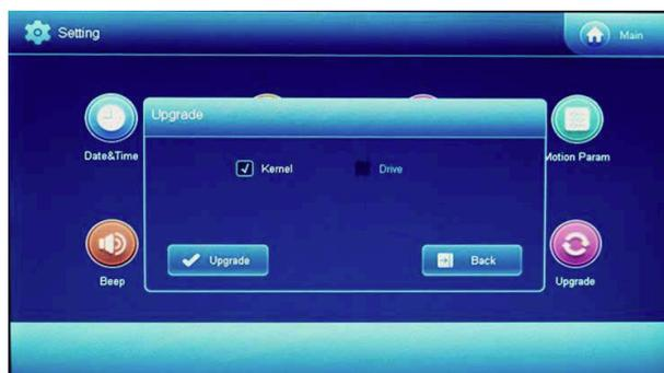
アップグレード完了後、画面の指示に従い、本体をシャットダウンし、アップグレード用USBメモリを取り外して、本体を再起動させてください。
