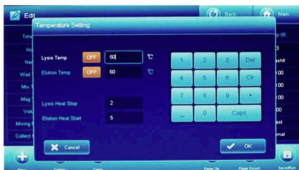
Lysis Temp (溶解温度)、Elution Temp (溶出温度)のON/OFFおよび温度を設定します。Lysis Heat Stop (溶解加熱終了ステップNo.)にはLysis加熱を終了するステップ番号、Elution Heat Start (溶出加熱開始ステップNo.)にはElution加熱を開始するステップ番号を入力します。
