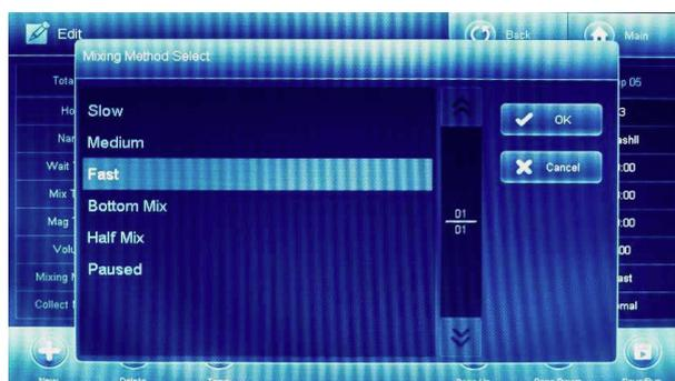
※振動回数の目安 (10秒あたり) : Slow: 約10回、Medium: 約20回、Fast/Bottom Mix/Half Mix: 約30回です。Pausedは設定した時間、動作を停止します。
