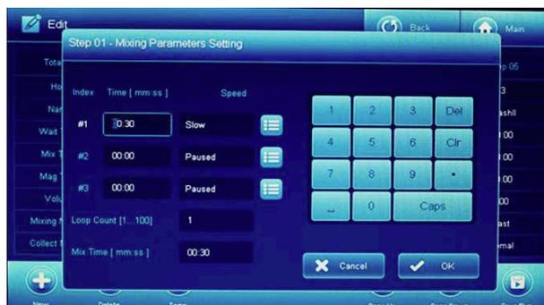
混合パラメータでは、混合ステップを最大3サイクルまで設定することができます。混合ステップを使用しない場合は、時間を00:00に設定します。混合ステップのリストボックスをクリックすると、混合スピードを選択することができます。
