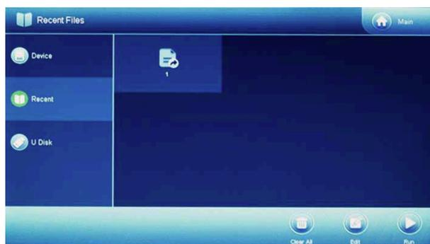
前回までに編集・実行された9つのファイルのリストが中央に表示されます。現在選択されているファイルは、白色で表示されます。現在選択されているファイルをクリックすると、Edit画面に入ります。下段には、Clear All（履歴削除）、Edit（編集）、Run（実行）ボタンがあります。
