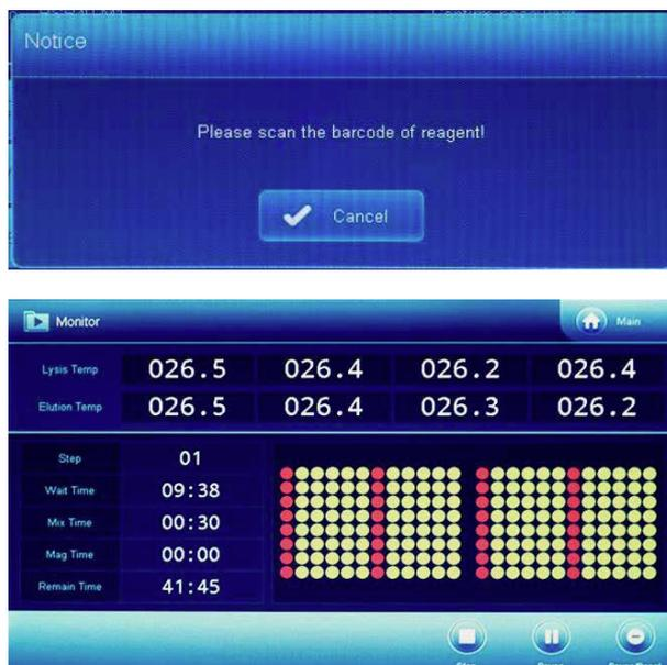
Monitor画面の上部に溶解温度と溶出温度が表示されます。
