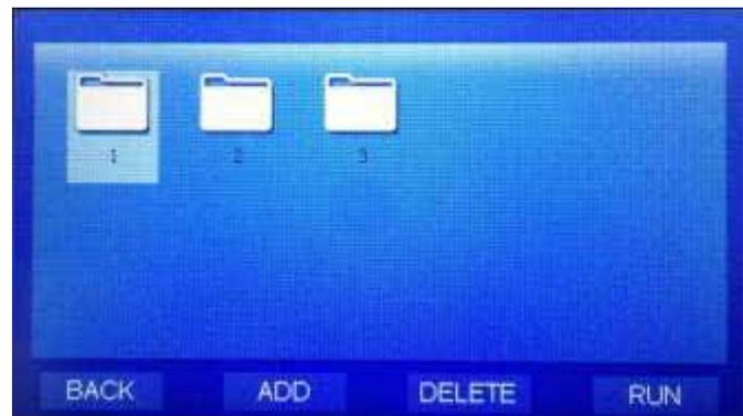
ファイルリスト画面で“Delete”（削除）をクリックすると、削除してよいか確認するメッセージボックスが表示されます。ファイルの削除を確定するときは“YES”（はい）を、削除をキャンセルする場合は“NO”（いいえ）をクリックします。操作が終わるとファイルリスト画面に戻ります。
