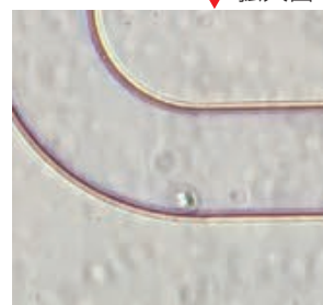
バタフライ型の流路中にあるシングルセルの例 キャプチャーサイトに細胞がなくても、バタフライ型の 流路中にシングルセルがあればゲノム増幅が行われる。
