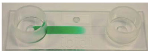
図2 : 緑色で着色した溶液を用いた場合の濃度勾配の画像
